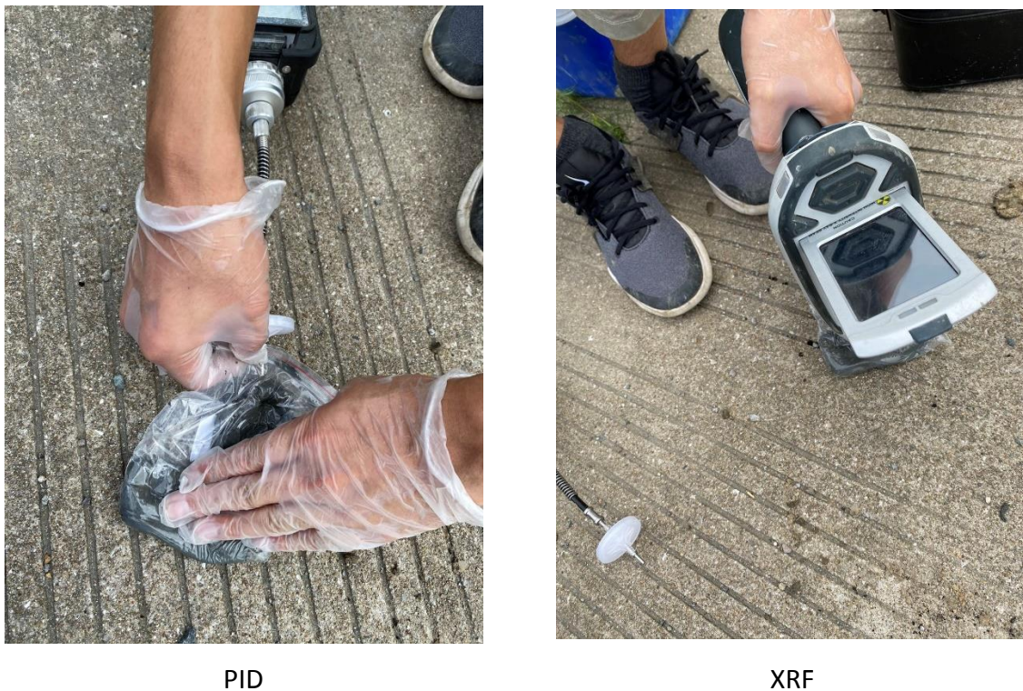
图 5.3-2 土壤现场快速检测情况
