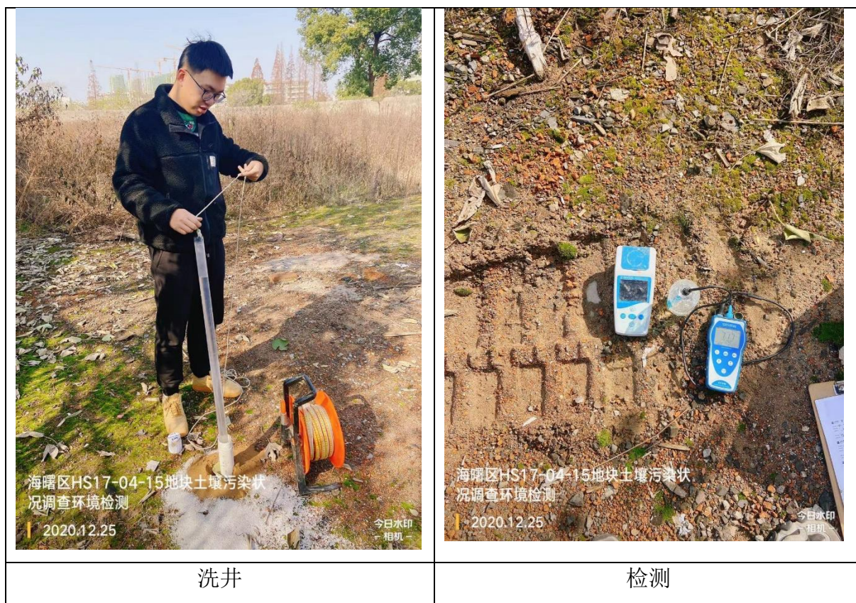
图 5.3-4 现场洗井、检测情况
