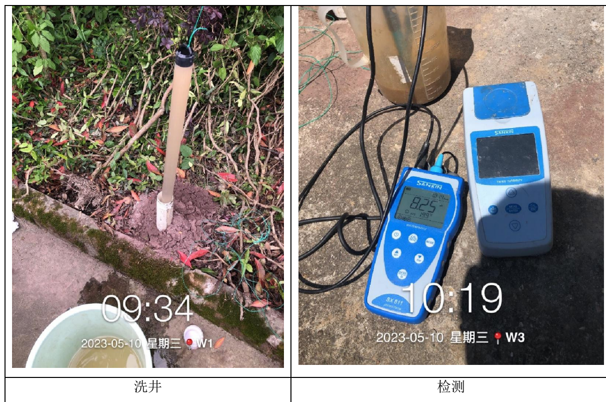
图 4.3-10 洗井及检测过程
