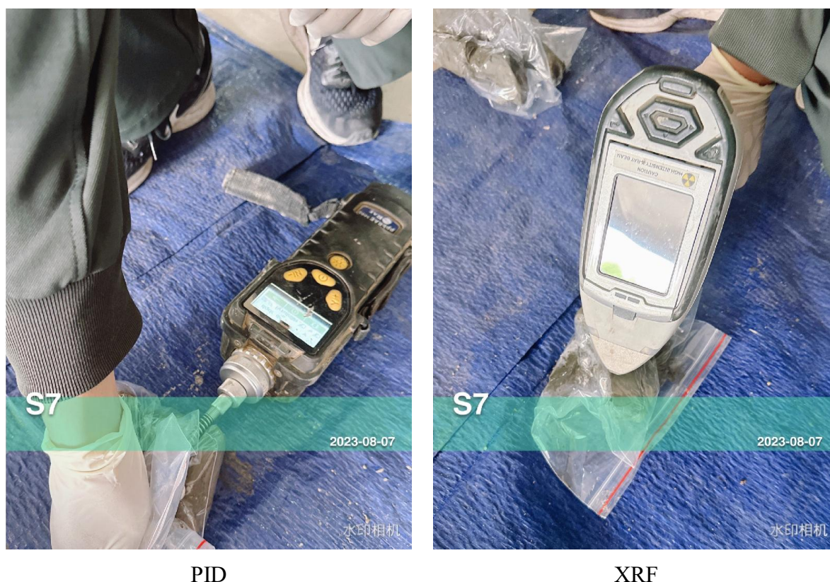
图 3.3-2 土壤现场快速检测情况
