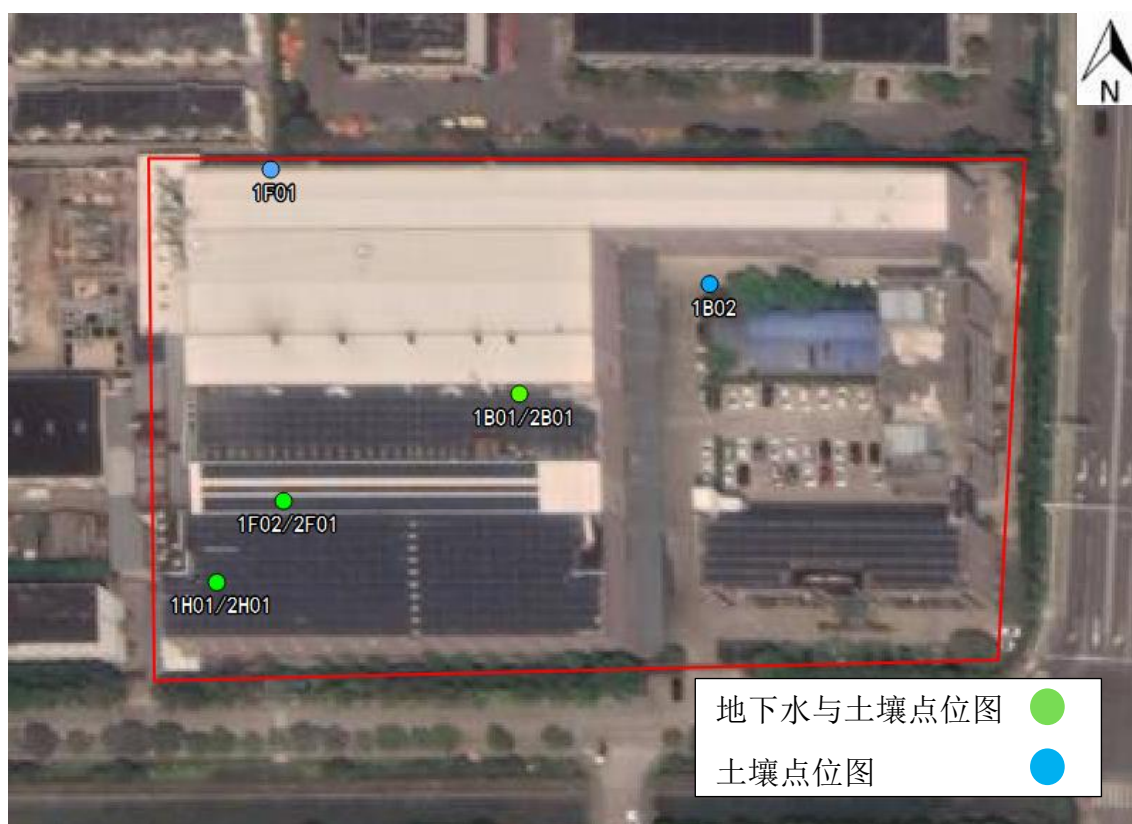
图 6.1-1 土壤和地下水布点图
