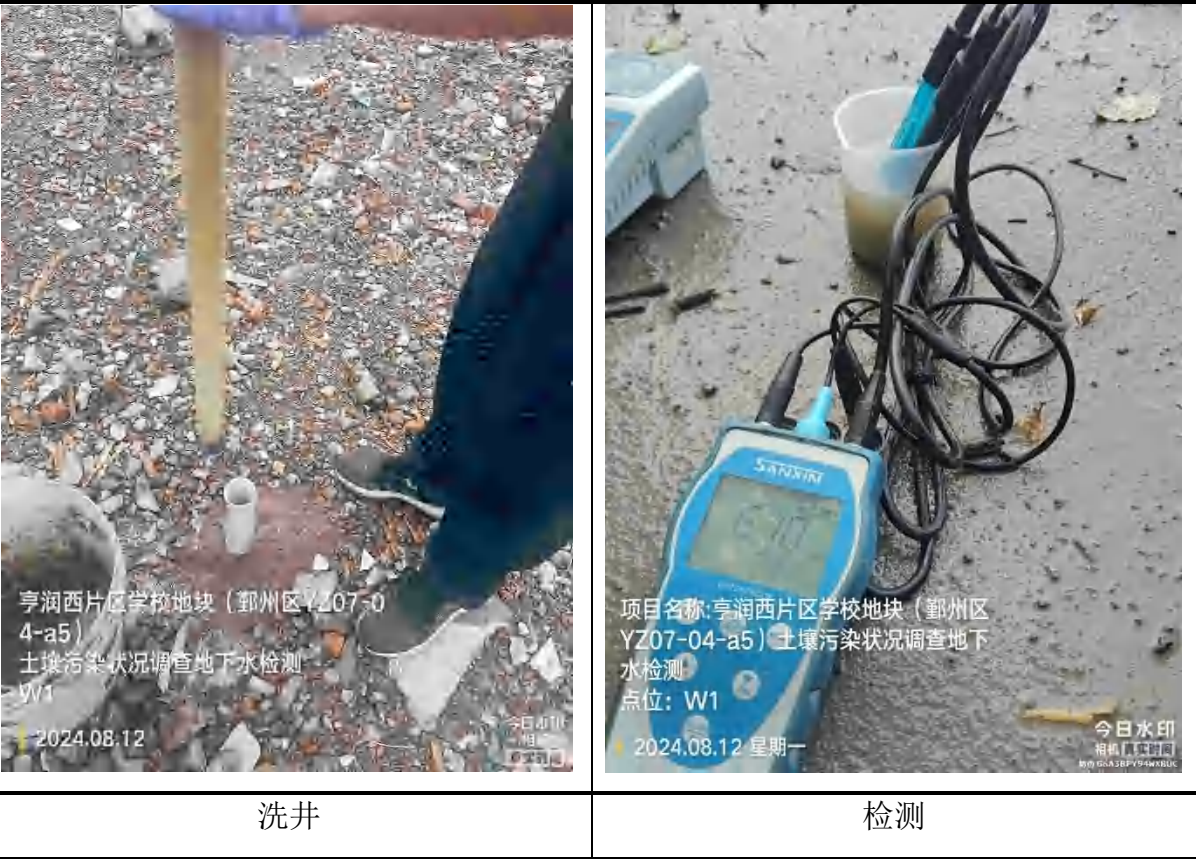
图 5.2-10 现场洗井、检测情况
