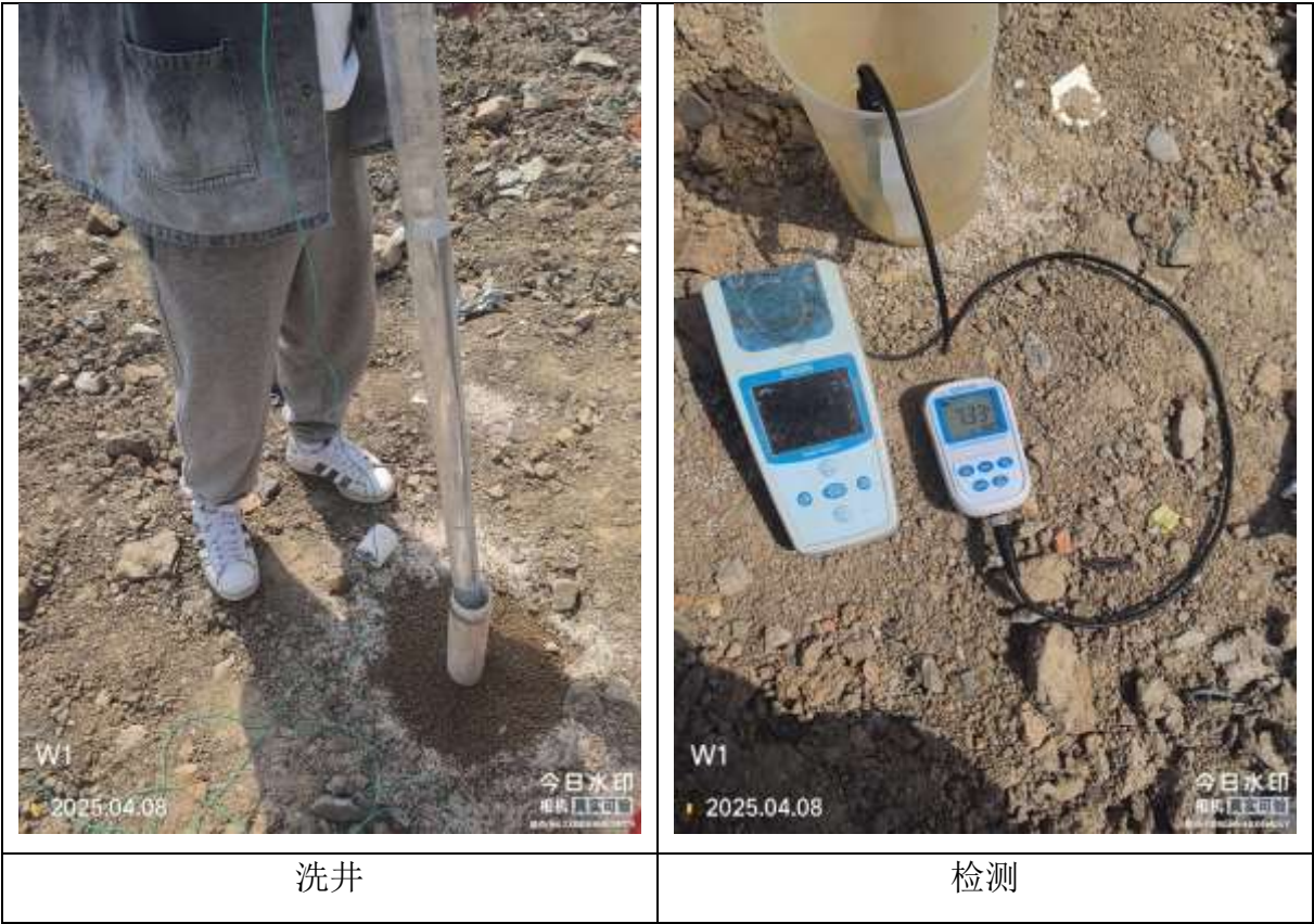
图 5.2-9 现场洗井、检测情况
