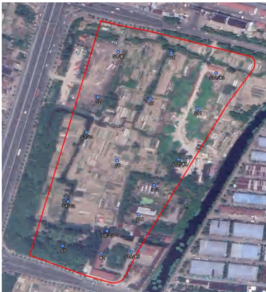
图 2.4-5 D#安置房地块布点图（引自《慈溪新城河区块综合改造 D#安置房工程地块土壤污染状况调查报告》（2021 年 5 月））
