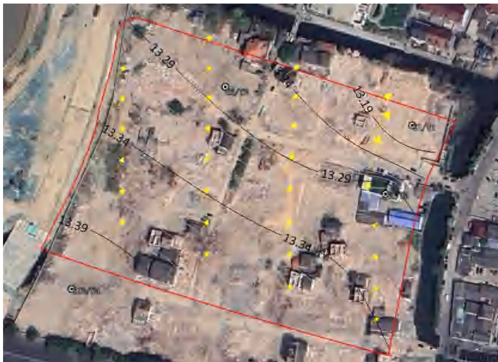
图 2.1-9 新城河区块 59-B 地块地下水流场图（引自《慈溪市新城河区块 59-B 地块土壤污染状况调查报告》（2023 年 3 月））
