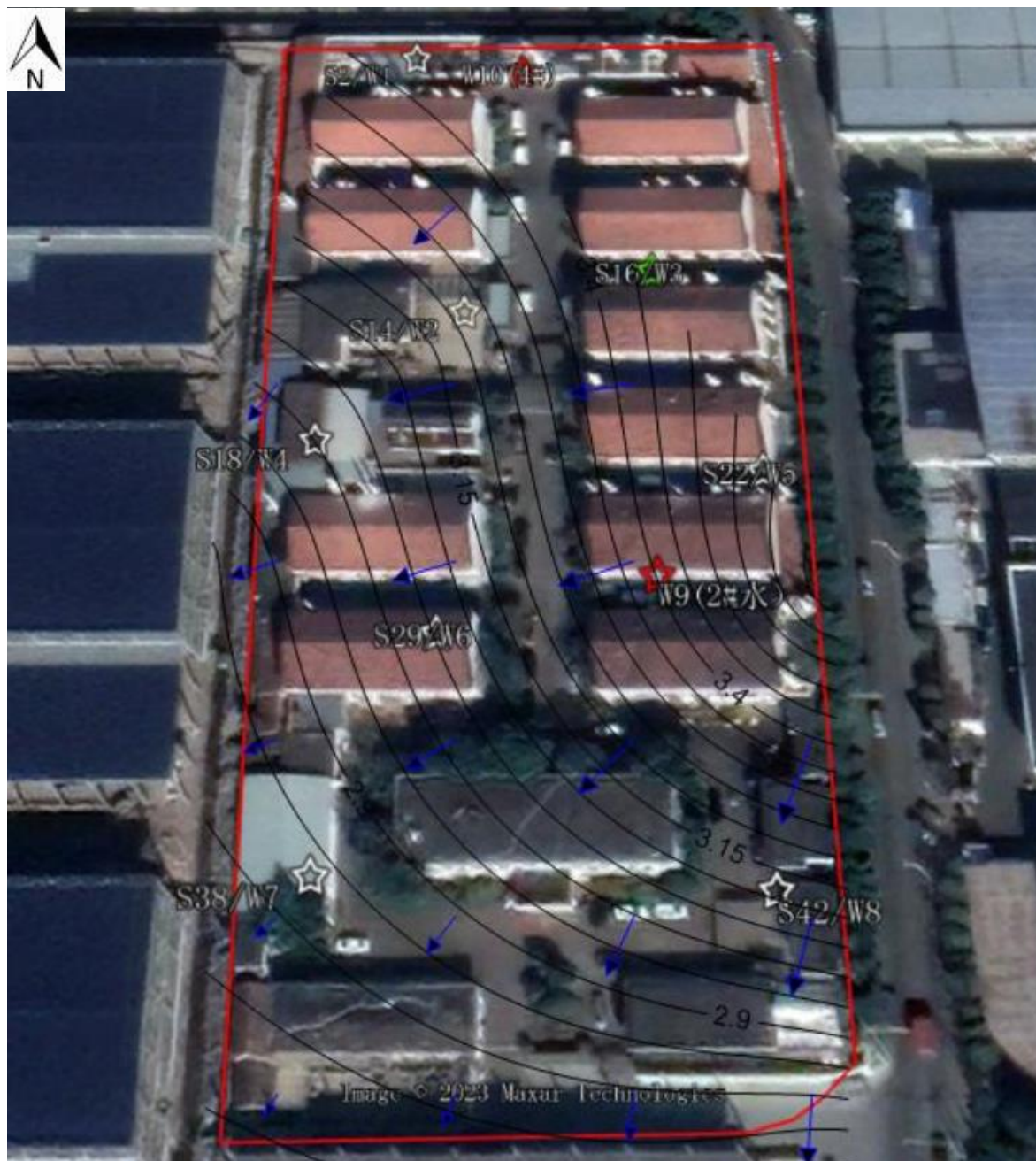
图 3.2-4 本地块初调工作地下水流向测绘图
